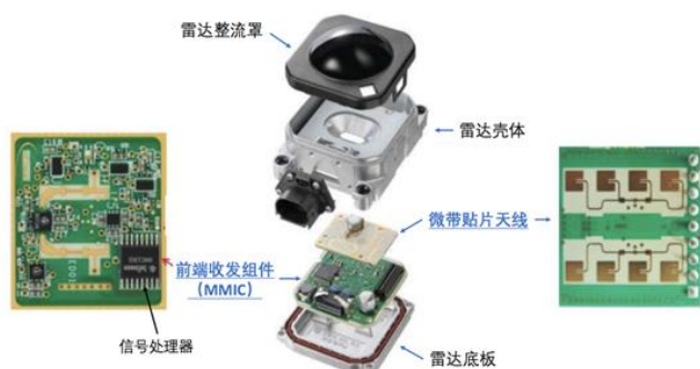
图表 30：毫米波雷达拆解图
